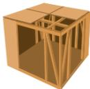
**木造軸組×耐力面材工法**
