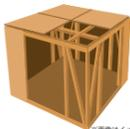
**木造軸組×耐力面材工法**
